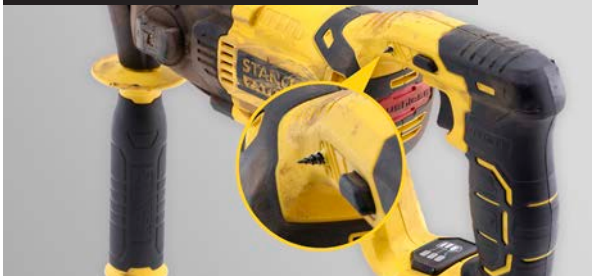
Το εργαλείο επισκευάστηκε εσφαλμένα
