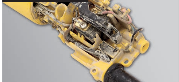
Καταστροφή από νερό
