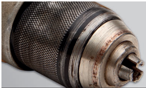
Χαλασμένο τσοκ - εργαλείο για το οποίο δεν έχει ληφθεί μέριμνα
