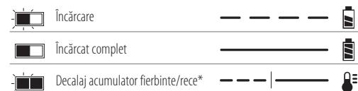
\*Indicatorul luminos roșu va lumina intermitent continuu, dar rămâne aprins un indicator luminos galben în timpul acestei operații. După ce acumulatorul a atins o temperatură corespunzătoare, indicatorul luminos galben se stinge și încărcătorul reia procedura de încărcare.
