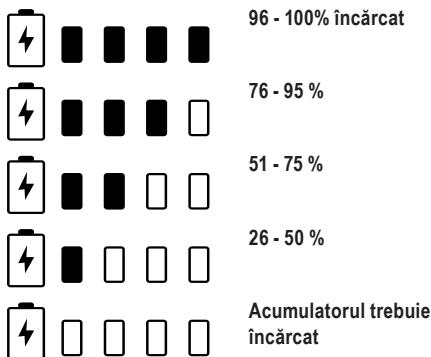
**Notă:** LED-ul pentru nivelul de încărcare va fi afișat doar atunci când butonul pentru starea de încărcare este apăsat.
